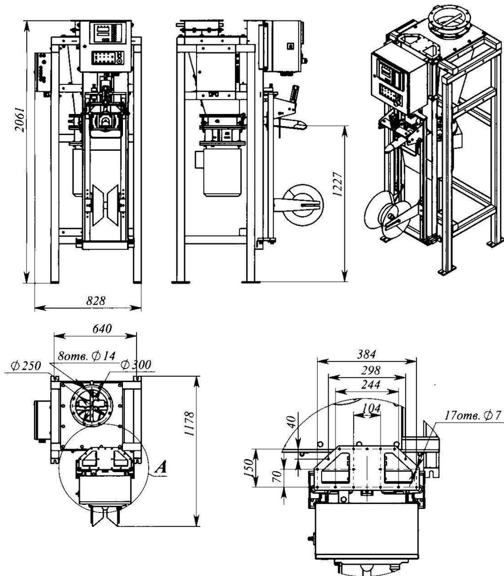
**Рис. 1. Габаритно-установочные размеры.**
